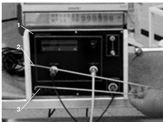
Рис. 1. Внешний вид микроволнового генератора «Гемостаз» с 5-мм жесткими лапароскопическими МВ-антеннами (НПО «Торий», Москва).
